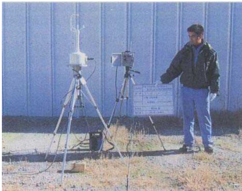
図Ⅲ－1 大気調査実施状況 (右：環境大気試料採取装置、左：風向・風速計)
