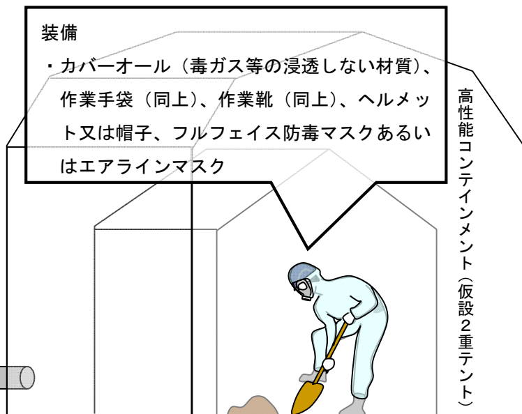
図Ⅶ-1 注意事項レベル別の掘削方法、装備等の概要
